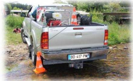
Les pêches totales à pied ont été réalisées à l'aide d'une anode (cours d'eau < 4 m de large) à 2 anodes (6 à 15 m) avec un matériel fixe à groupe électrogène (Héron, Dream électronique) embarqué sur un véhicule 4\*4.
