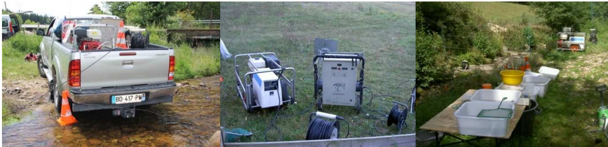
Photographie 1 : Matériel de pêche électrique de type Héron et atelier de biométrie.
